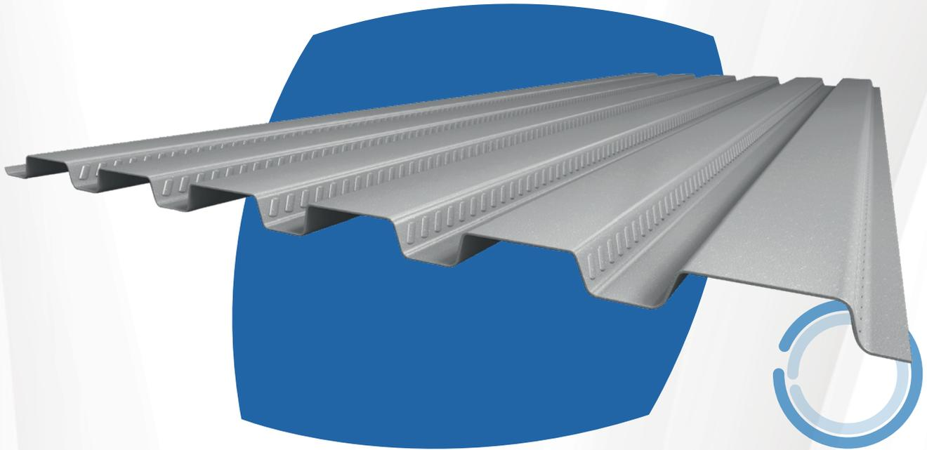
Es un sistema de losa compuesta, formada por un perfil de lámina de acero galvanizado y concreto, el perfil está diseñado para anclarse al concreto y formar una losa reforzada, donde el perfil de lámina absorbe el momento positivo.
